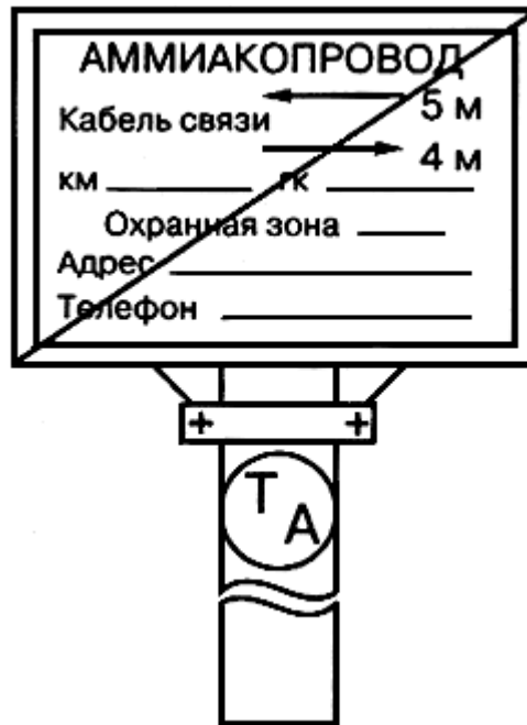
Знак пересечения аммиакопровода с трубопроводами
