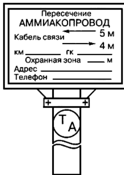
Опознавательные знаки аммиакопровода и кабеля связи
