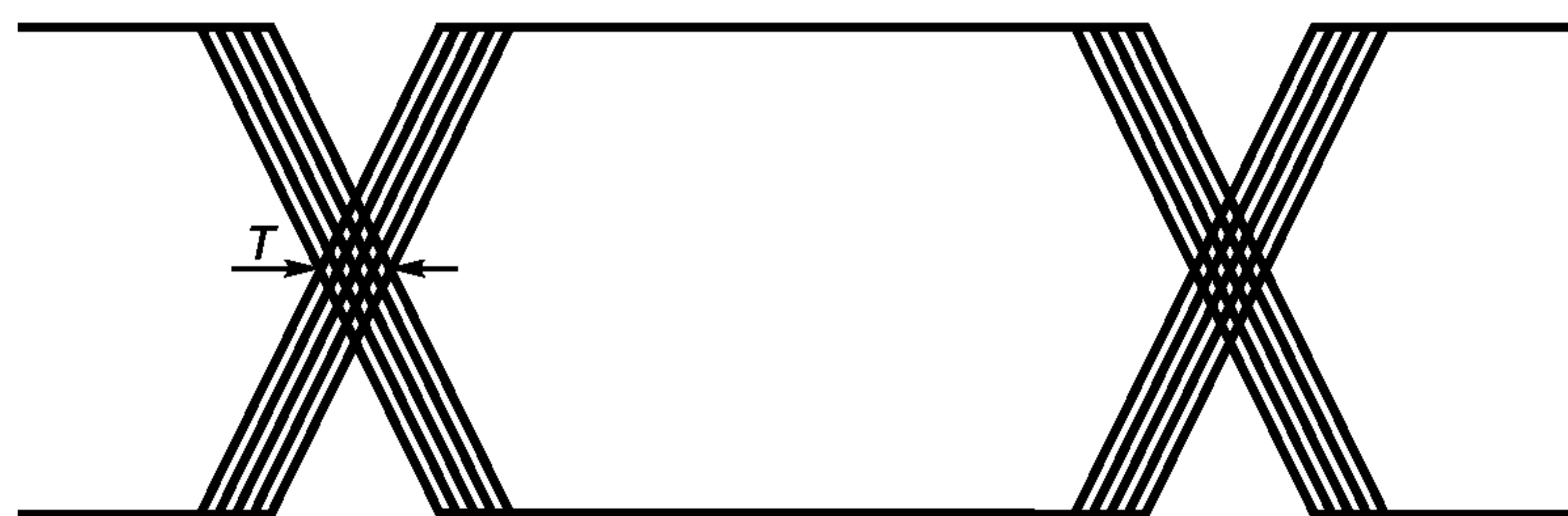
Рисунок 8 — Диаграмма, поясняющая измерение фазового дрожания цифрового сигнала
