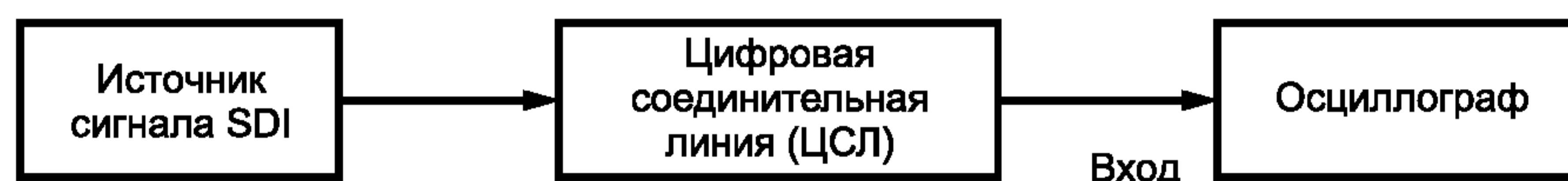
Рисунок 1 — Схема измерений размаха сигнала, уровня постоянной составляющей, времени нарастания и спада импульсов и выбросов переходного процесса при нарастании и спаде импульсов
