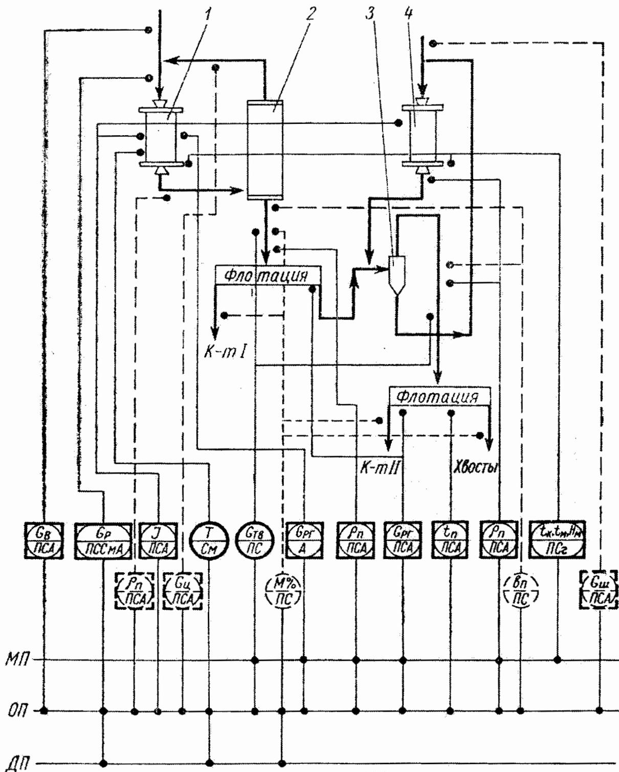
Рис. 6. Схема автоматизации двухстадийного измельчения с межцикловой флотацией:
