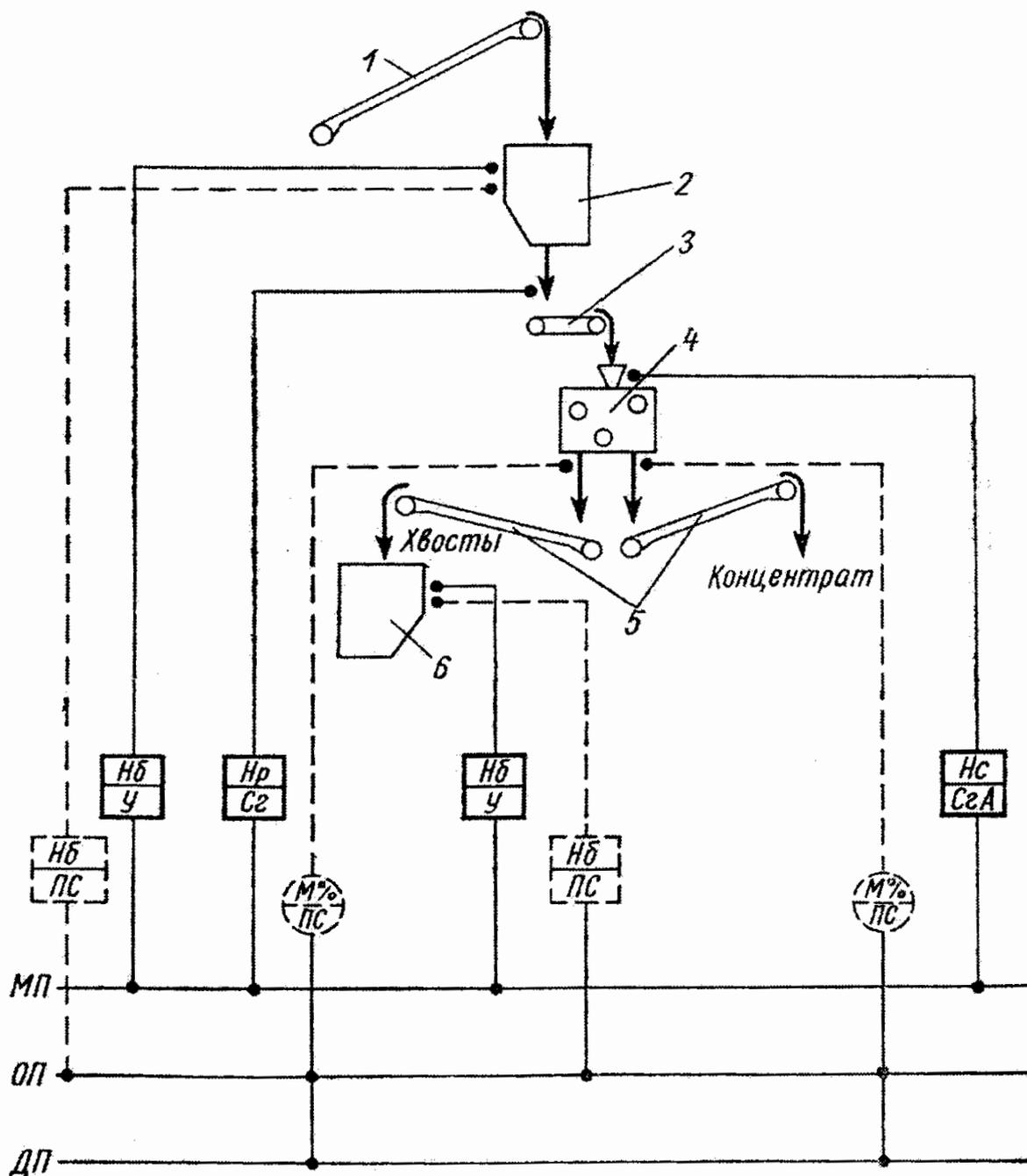
Рис. 7. Схема автоматизации сухой магнитной сепарации:
