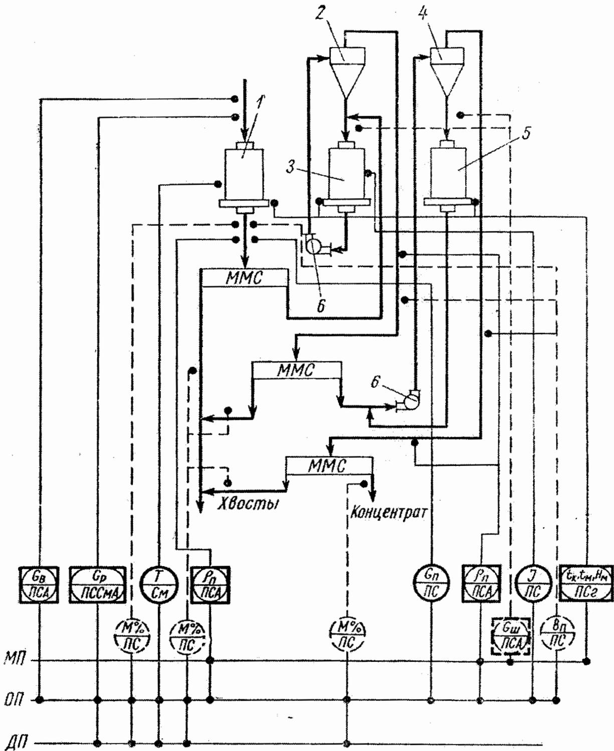
Рис. 10. Схема автоматизации трехстадийного измельчения с замкнутым циклом во II и III стадиях и магнитной сепарацией после I, II и III стадий:
