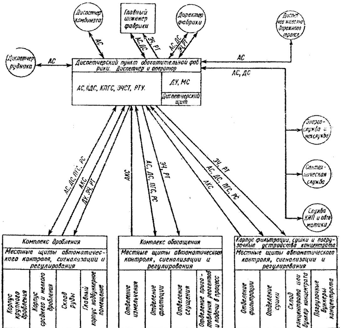
Рис. 1. Одноступенчатая схема управления обогатительной фабрики:
