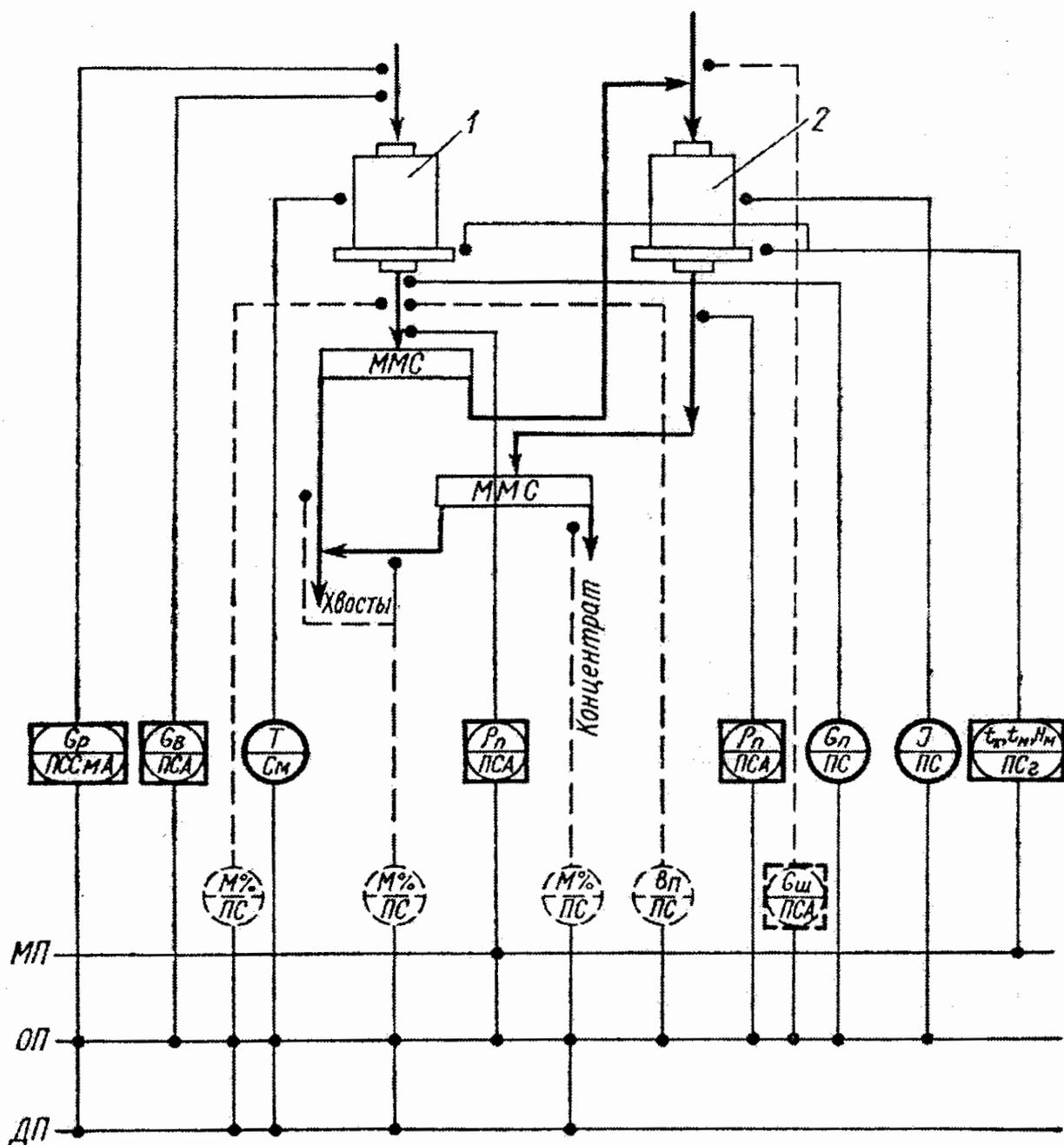
Рис. 8. Схема автоматизации двухстадиального измельчения в открытом цикле с магнитной сепарацией после I и II стадий измельчения:
