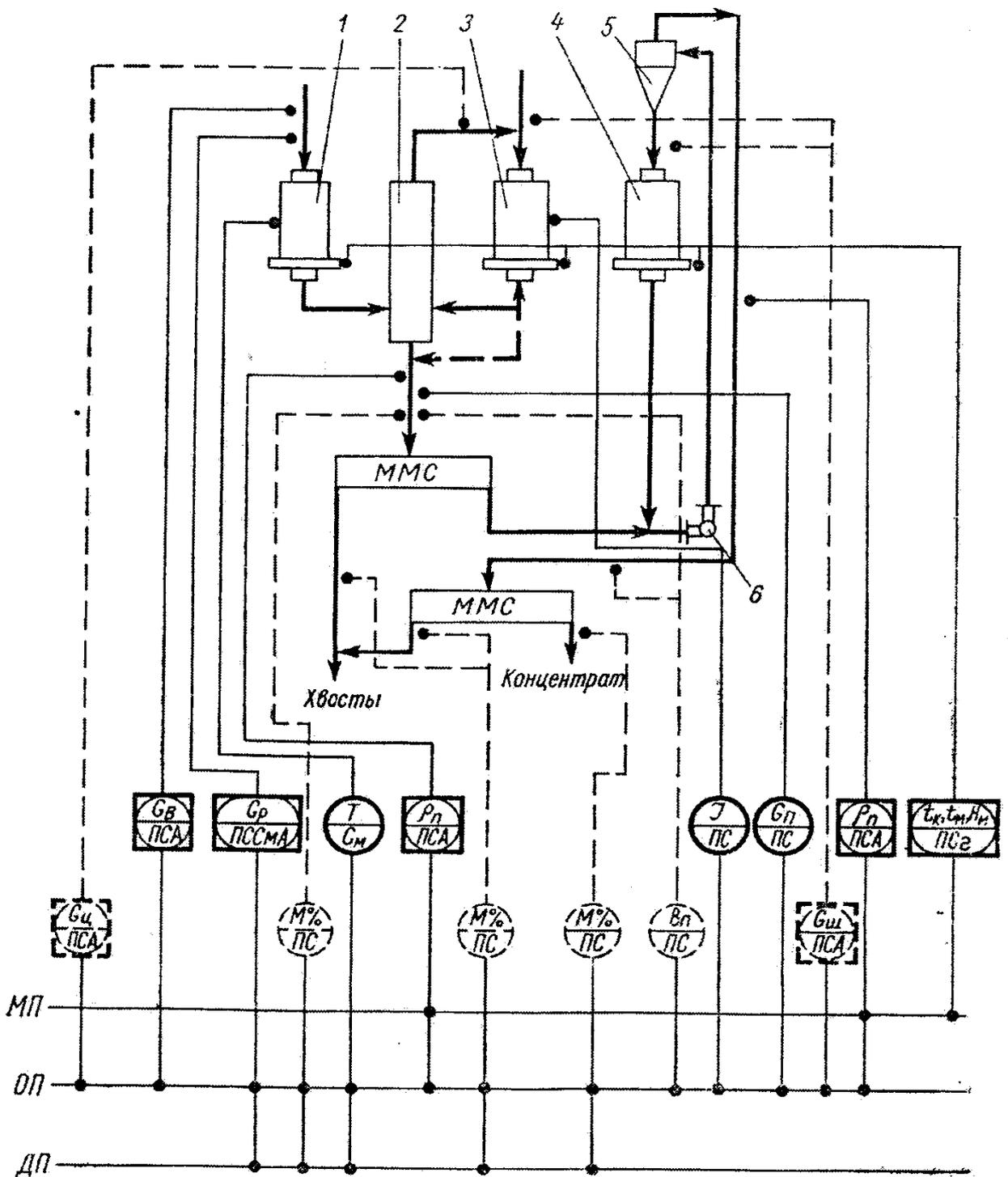
Рис. 9. Схема автоматизации трехстадийного измельчения с магнитной сепарацией после II и III стадий измельчения:
