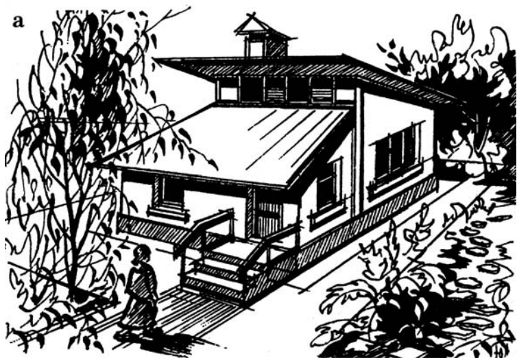
Рис. 113. Садовый домик каркасной конструкции со стеновым заполнителем из бросового материала с мансардным этажом. а — общий вид дома со стороны крыльца.
