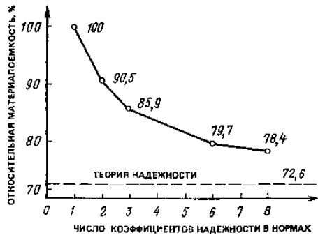
Рис. 5.5. Падение относительной материалоемкости с увеличением гибкости формата норм при одинаковой допустимой вероятности отказа
