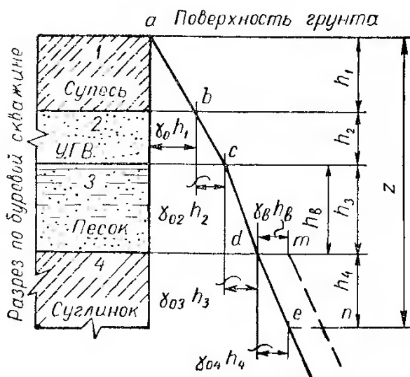
Рис. 9. Эпюра напряжений p_{bz} от собственного веса грунта
