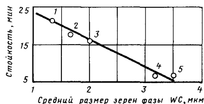
Рис. 1.4. Зависимость стойкости реза от среднего размера зерна фазы WC при точении серого чугуна СЧ 30. Резец оснащен сплавами:
