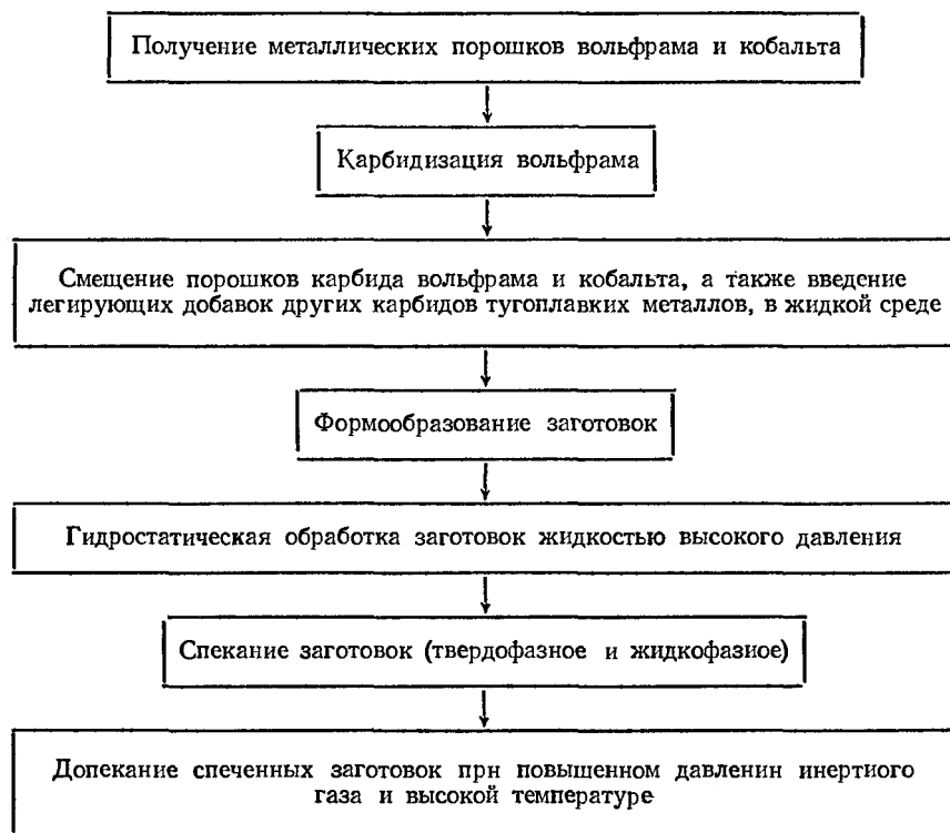
Рис. 7.9. Укрупненная технологическая схема производства заготовок из сплавов на основе WC—Co для оснащения инструмента, предназначенного для обработки металлов давлением
