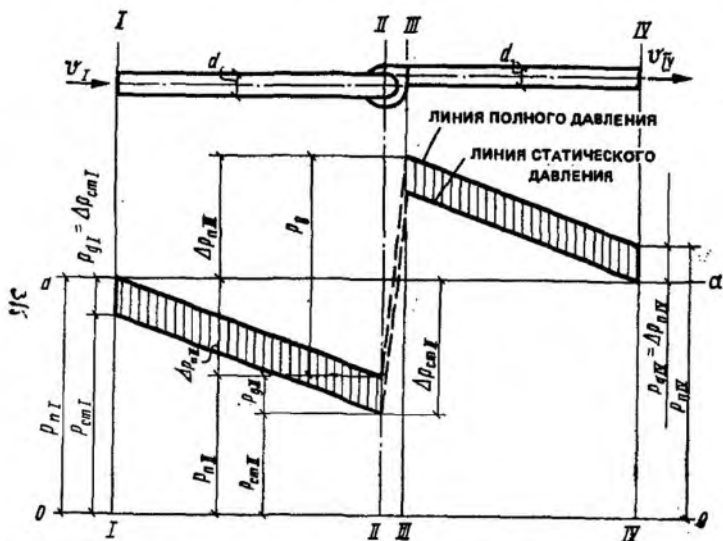
Рис. 8. Эпюра распределения давлений в воздуховоде 0—0 — линия абсолютного вакуума; а—а — линия барометрического давления
