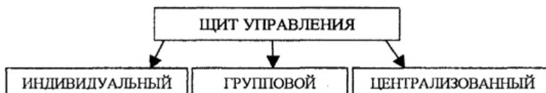
Рис. 9.2. Типы щитов управления теплогенерирующими установками
