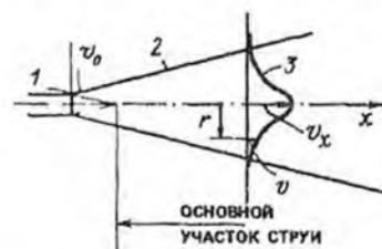
Схема свободной приточной струи 1 — пазок для подачи воздуха; 2 — граница струи; 3 — эпюра поля скорости в сечении х
