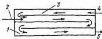
Схема регенератора активного ила 1 — азротенк; 2 — исходная сточная вода; 3 — регенератор; 4 — циркуляц. активный ил; 5 — иловая смесь во вторичные отстойники
