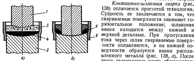
Рис. 138. Схемы контактно-шлаковой сварки:
