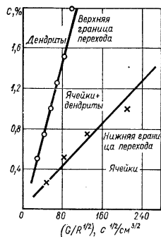
Рис. 4. Критические условия затвердевания, при которых ячейчатая форма кристаллизации переходит в дендритную (сплав олова со свинцом)
