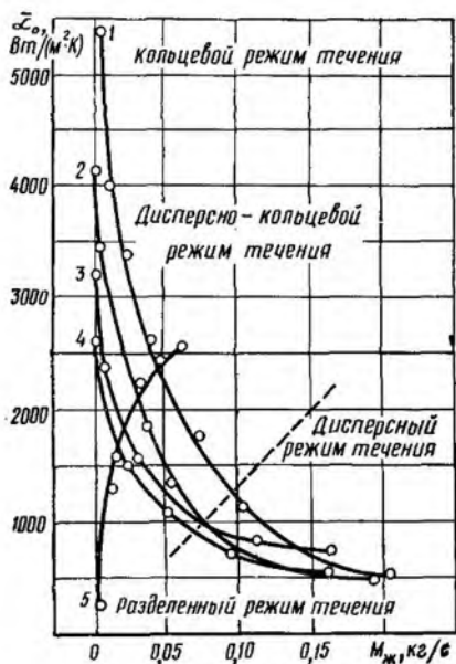
Рис. VI.3. График зависимости \bar{\alpha}_0 = f(M_{\text{п}}; M_{\text{ж}}) для горизонтальной трубы диаметром 0,032\text{ м} при значениях M_{\text{п}} , кг/с:
