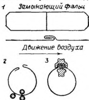
Рис. 117. Последовательность операций при изготовлении воздуховодов диаметром до 215 мм
