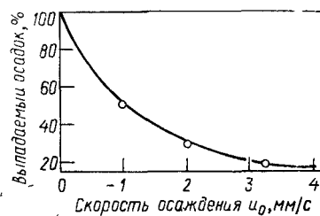
Рис. II-12. Зависимость эффективности отстаивания от скорости осаждения.
